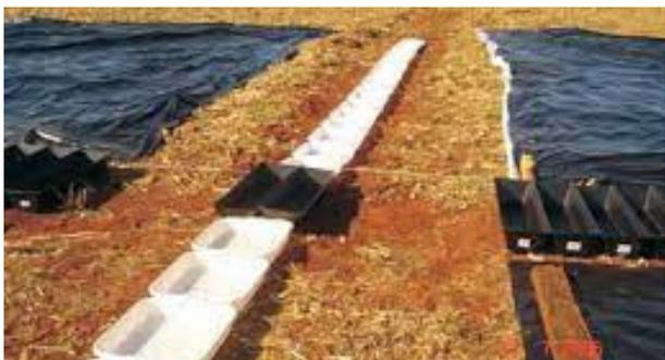
Teste de regulagem de distribuidor a lança (teste da bandeja)
