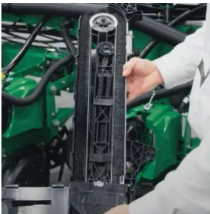
O que pode ser um ponto chave para a escolha de um sistema pneumático e condutores com escova é a possibilidade de operar sua máquina em uma maior velocidade, realizando uma semeadura mais rápida e precisa.
